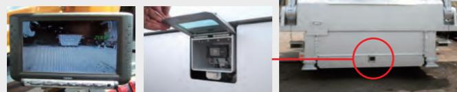
6.5インチモニター メンテナンスカバー 後方カメラの設置例
